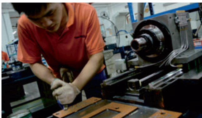
Шабрение монтажной поверхности
