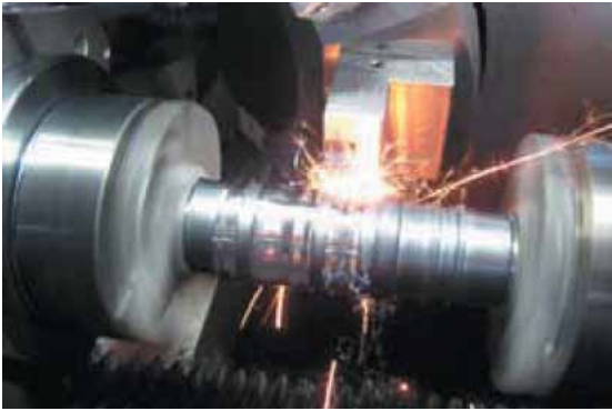
Синхронная обработка в двух шпинделях
