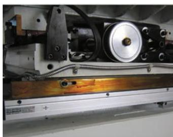
Конструкция привода аналогична швейцарским станкам. Использование измерительных линеек по 3 осям для обеспечения точности и достижения замкнутого цикла.
