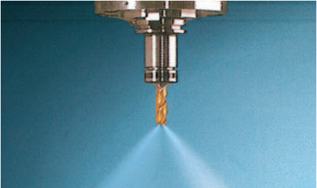
Подача СОЖ через шпиндель (20/30/70 бар)
