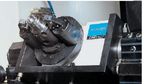
Индексация / Дополнительные 4 и 5 оси
