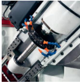
Шпиндель со сборной дисковой фрезой
