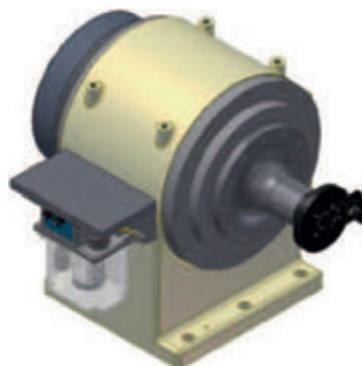
Передняя бабка станка имеет центральное отверстие для удлиненных заготовок
