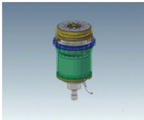
Стол заготовки приводится во вращение высокомоментным мотор-шпинделем
