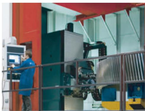
На жесткой станине установлен стол с прямым приводом
