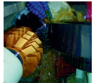
Фрезерный шпиндель с двумя червячными фрезами
