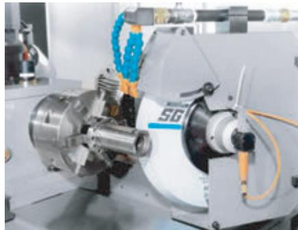
Шлифование наружного диаметра и торца гайки ШВП
