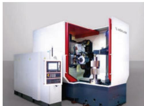
На жесткой станине установлен стол с прямым приводом
