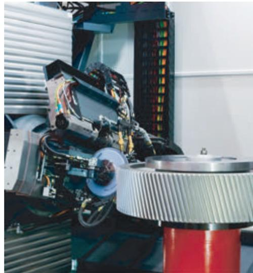
Высокоэффективная 5-осевая шлифовальная головка
