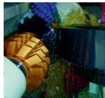
Фрезерный шпиндель с двумя червячными фрезами
