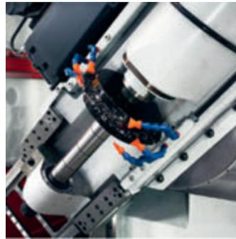
Шпиндель со сборной дисковой фрезой
