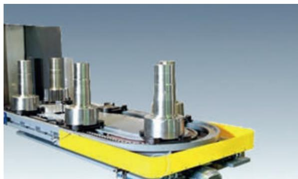
Станок подготовлен с автоматизации, включая возможность загрузки-выгрузки деталей на конвейер
