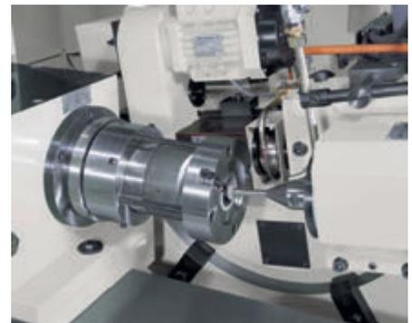
Шлифование резьбы в отверстии небольшого диаметра
