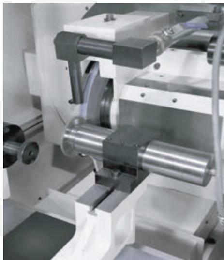
Система автоматического профилирования круга алмазным диском
