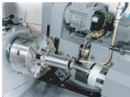
Шлифование внутренней резьбы гайки ШВП
