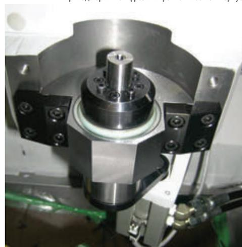
Гидрозажим оправки фрезы сокращает время смены инструмента
