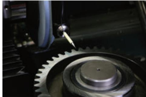
Встроенная система измерения
