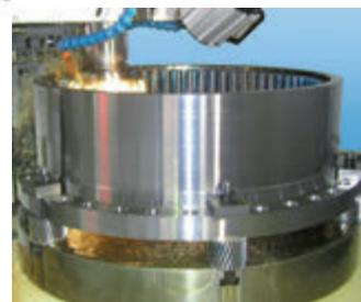
Для обработки венцов с шириной большей, чем рабочий ход головки можно применить метод «Шаттл», который позволяет обрабатывать единый венец за несколько проходов постепенно смещая зону рабочего хода.
