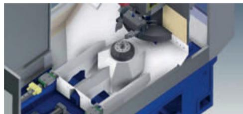
Кожухи из нержавеющей стали защищают узлы станка от СОЖ и стружки
