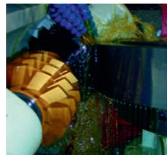
Фрезерный шпиндель с двумя червячными фрезами
