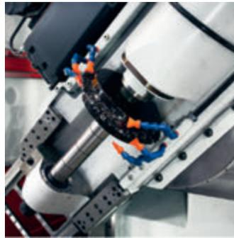
Шпиндель со сборной дисковой фрезой
