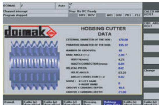
Удобный интерфейс настройки станка на обработку
