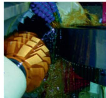
Фрезерный шпиндель с двумя червячными фрезами
