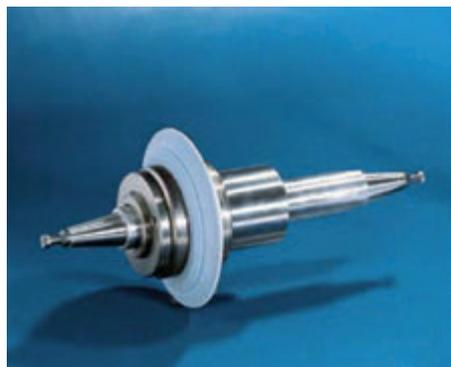
Использование абразивного профильного круга
