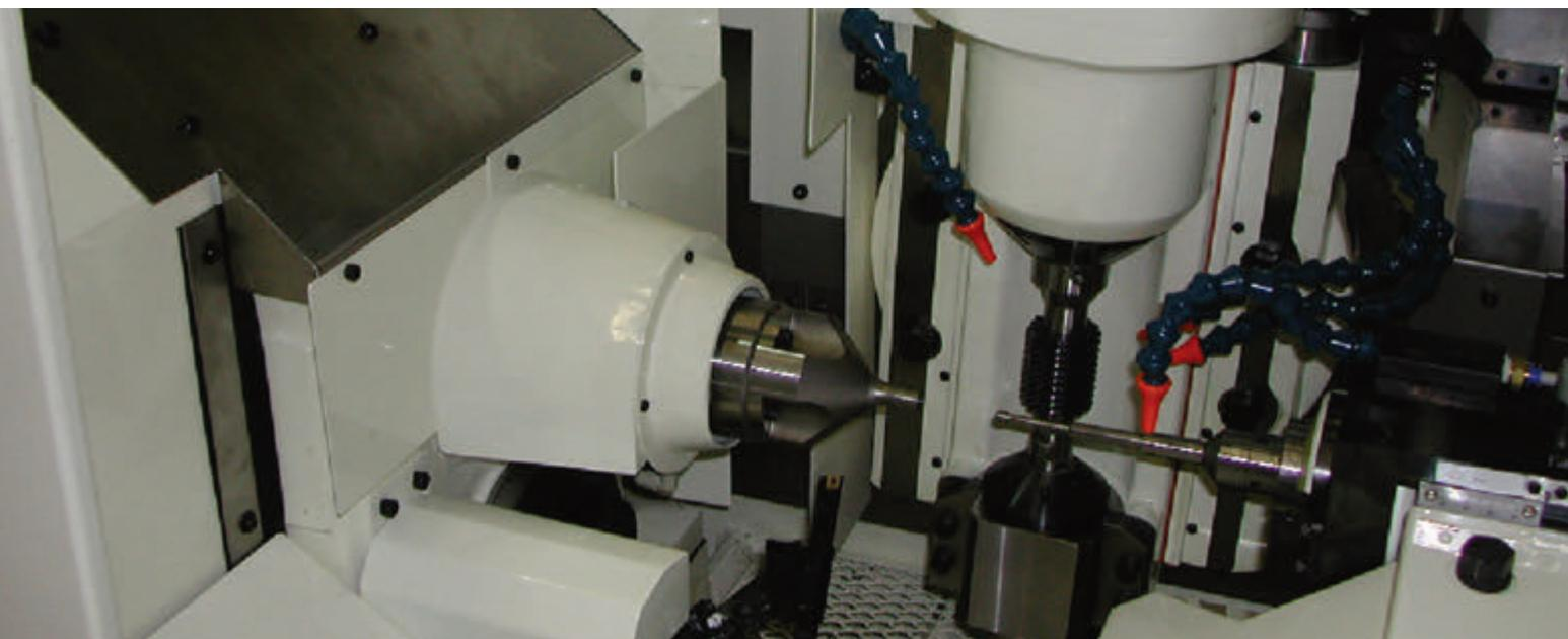
Зубообрабатывающие станки компании HAMAI (Япония) отличаются надежностью, скоростью, компактностью и стабильностью обработки. Эти машины оказываются незаменимыми при обработке малых зубчатых колес и валков-шестерен с высокой точностью. А вместе с удобным станком для заточки червячных фрез GN150 можно значительно повысить производительность участка зубообработки.
