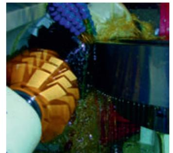
Фрезерный шпиндель с двумя червячными фрезами
